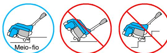
**POR SEGURANÇA:** Quando transportar a máquina, não levante ou desça as rodas nas escadas. Peça assistência ou use um elevador mecânico quando suspender a máquina.
