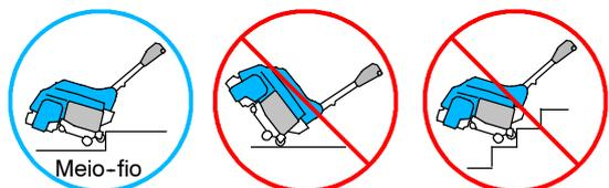
**POR SEGURANÇA:** Quando transportar a máquina, não levante-a sobre as rodas traseiras e não suba ou desça com as rodas nas escadas. Peça assistência ou use um elevador mecânico quando suspender a máquina.
