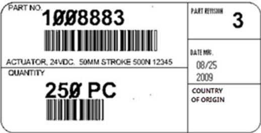
图 7.3 标签尺寸 2”x 4” (50mm x 100mm)
