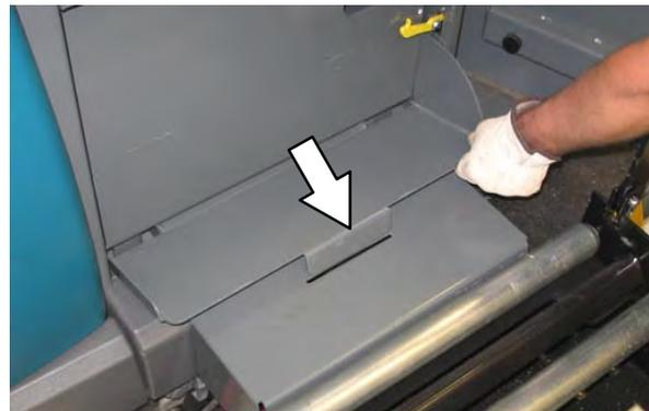
6. Para poder aplicar el freno del carrito de la batería, pise el lado izquierdo del freno de suelo.
