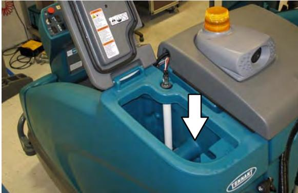
2. Retire la cubierta del compartimento ec-H2O.
