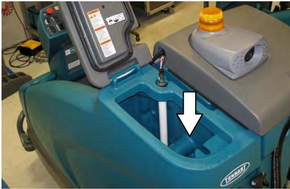
11. Introduzca la manguera de salida del sistema ec-H2O en un recipiente vacío.
