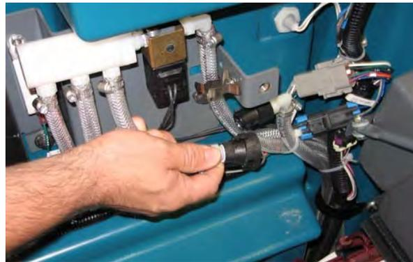
5. Introduzca la manguera de vaciado en un recipiente vacío.
