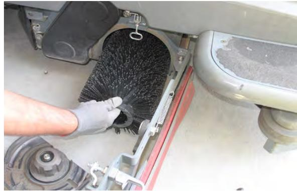
5. Coloque el cepillo con el extremo de la doble fila mirando hacia la abertura del cabezal de fregado. Introduzca el cepillo nuevo en el cubo de transmisión.
