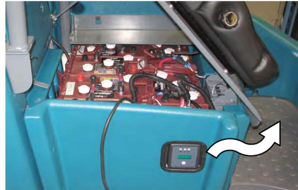
5. Retire la pieza que sujeta el cargador de baterías incorporado a la máquina.
