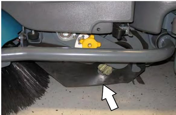
Controle el deterioro y desgaste de las aletas cada 50 horas de utilización.
