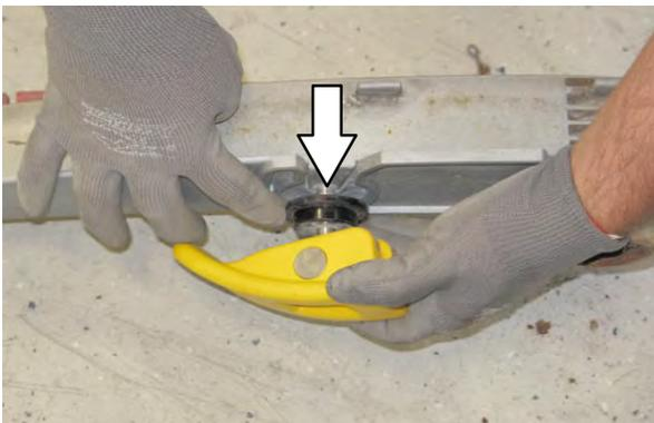
8. Retire el bastidor interior del bastidor exterior.
