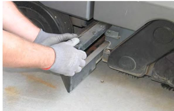
**NOTA:** Para retirar el depósito de desperdicios, debe bajarse el cabezal de fregado aproximadamente 25 mm.
