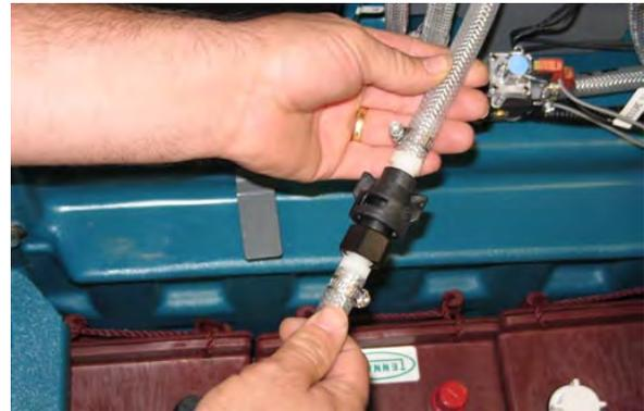
6. Introduzca la manguera de vaciado en un recipiente vacío.
