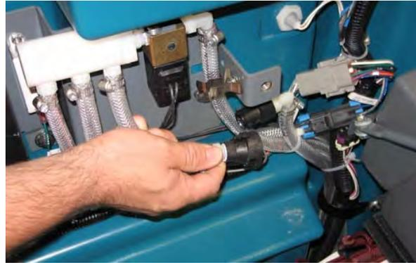
5. Conecte la manguera de vaciado a la manguera del colector ec-H2O desconectada de la manguera de salida en el paso anterior.
