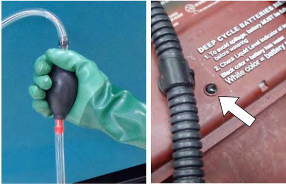
6. Después de añadir agua, sustituya el capuchón antipolvo de la manguera de llenado de la batería y guarde la manguera de la bomba manual dentro del compartimento de las baterías de la máquina para volver a utilizarla más adelante.
