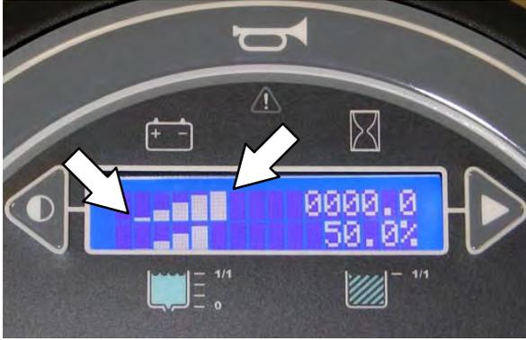
Cuando las baterías están totalmente cargadas, las cinco barras luminosas están encendidas. Recargue las baterías cuando solo quede una barra encendida en la pantalla. No deje que las baterías se descarguen por debajo de la última barra.
