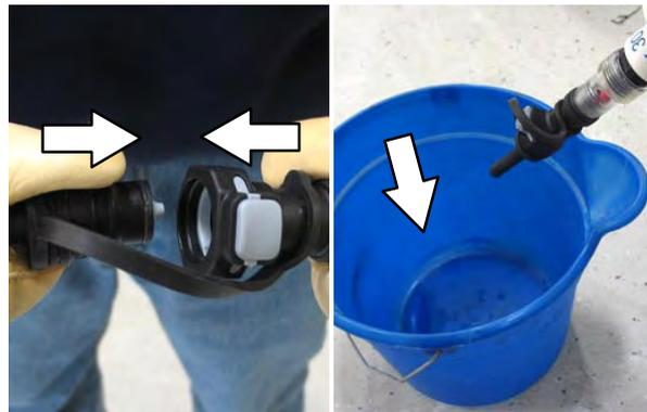
4. Retire la tapa antipolvo del tubo de llenado de la batería y conecte el regulador de llenado.
