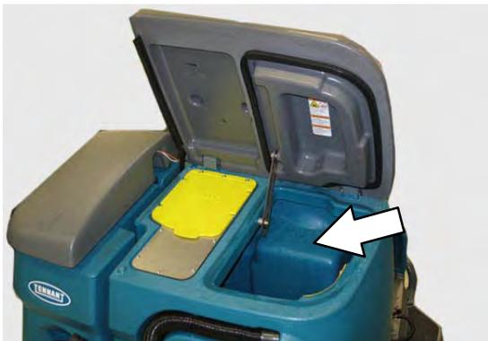
4. Llene el depósito de recuperación con agua (a no más de 140 °F/60 °C). Llene el depósito de recuperación hasta justo por encima del filtro del sistema ES. Cierre la tapa del depósito de recuperación.
