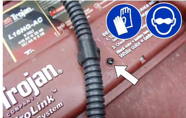
3. Localice el acoplador de la manguera de llenado de la batería del interior del compartimento de las mismas. Saque el capuchón antipolvo y conecte la manguera de la bomba manual.
