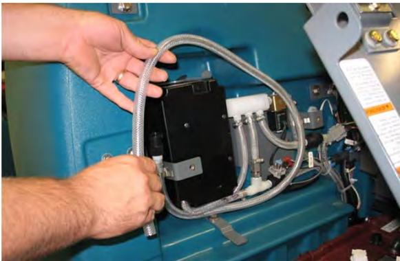
4. Desconecte la manguera de salida de la manguera conectada al colector ec-H2O.
