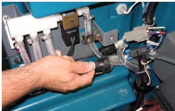
9. Conecte la manguera de vaciado a la manguera del colector ec-H2O desconectada de la manguera de salida en el paso anterior.
