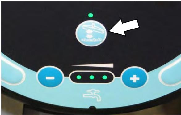
Active el flujo de disolución: Pulse el *botón de encendido y apagado de la disolución* para activar el flujo de disolución. Volverán a encenderse los indicadores luminosos de disolución y el flujo de disolución volverá por defecto al ajuste utilizado la última vez.
