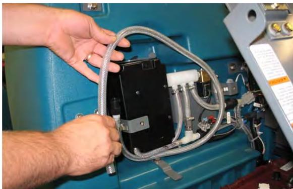
4. Desconecte la manguera de salida del cabezal de fregado de la manguera del colector ec-H2O.
