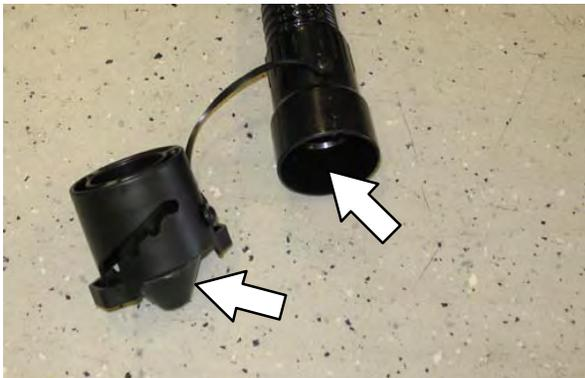
8. Cierre la conexión de la manguera de vaciado y vuelva a encajar la manguera de vaciado en el depósito de recuperación.
