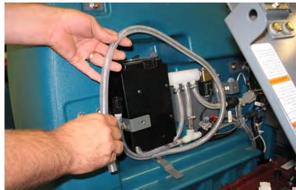
8. Desconecte la manguera de salida del cabezal de fregado de la manguera del colector ec-H2O.
