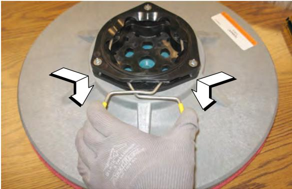
7. Empuje el nuevo cepillo por debajo del cabezal de fregado, alinee el adaptador del impulsor del cepillo con el eje de transmisión del cepillo y levante el cepillo para introducirlo en el eje de transmisión del cepillo hasta que encaje.
