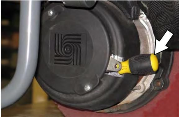
Empuje o remolque la máquina sólo *distancias muy cortas* y a una velocidad inferior a 3,2 km/h. La máquina NO está diseñada para ser empujada o remolcada grandes distancias ni a gran velocidad.
