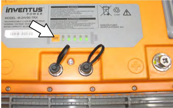
Para apagar la alimentación de la batería (mientras las baterías están activas), mantenga pulsado el botón de alimentación de cualquier batería durante **20 segundos**. Los indicadores de descarga de la batería se apagarán. Al apagar una batería se apagará la alimentación de todas las baterías conectadas. Las baterías deben apagarse antes de realizar cualquier mantenimiento en los módulos de baterías.
