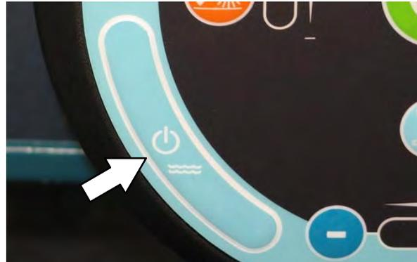
**BOTONES DE ENCENDIDO/APAGADO DE LA DISOLUCIÓN**
