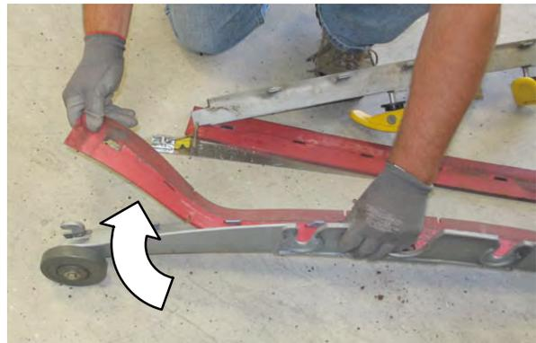
10. Introduzca girada la nueva lámina de la escobilla de goma en el bastidor exterior. Asegúrese de que la escobilla de goma esté totalmente introducida en cada lengüeta del bastidor exterior.
