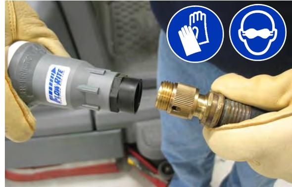
*NOTA:* la entrada de agua al sistema de riego con batería debe ser siempre de 7,57 LPM (2 GPM) o más. Utilice el purgador para confirmar la presión de la alimentación de agua. Consulte el Manual para operadores del sistema Flow-Rite si necesita más información.
