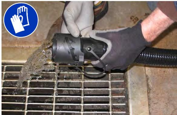
4. Si es necesario, coloque la boquilla de la manguera de vaciado en otra posición para ajustar la velocidad de flujo.
