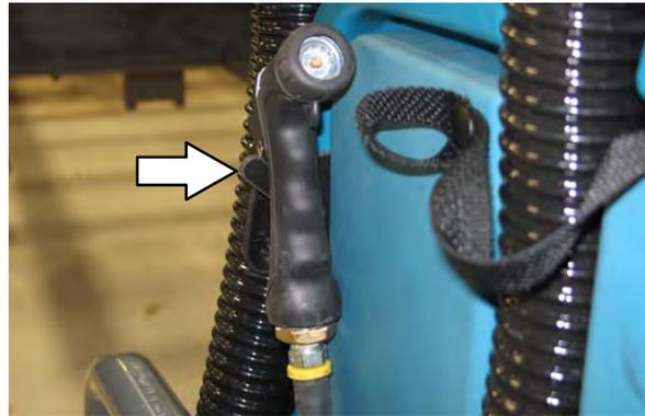
6. Para desactivar el suministro de agua, pulse la parte inferior del *interruptor de la boquilla de pulverización*. La luz del interruptor se apaga al desactivar la boquilla de pulverización.
