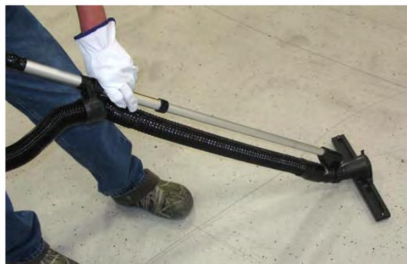
7. Cuando termine de aspirar, pulse el *botón de ventilador de aspiración/escobilla de goma* para desactivar el ventilador de aspiración. La escobilla de goma se subirá.
