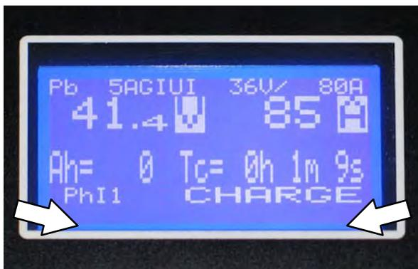
2. Observe la pantalla del cargador. Cuando la batería está cargando, CHARGE (Carga) aparece en la pantalla. Esta es la pantalla predeterminada del cargador.
