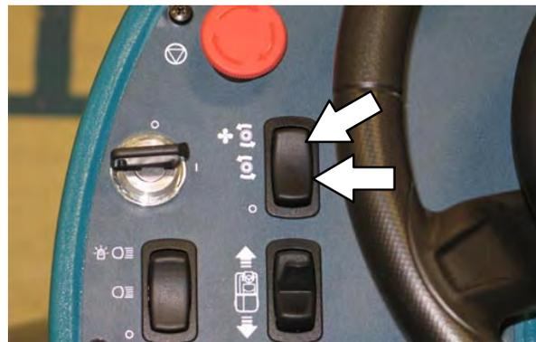
4. Pulse la parte inferior del *interruptor de barrido previo* para desactivar el sistema de barrido previo y el sistema de control de polvo.
