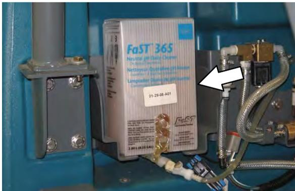
3. Abra el envase del nuevo FaST-PAK por las marcas perforadas. NO retire la bolsa del envase. Retire el conector de la manguera situado en la parte inferior de la bolsa y retire el tapón de la manguera del conector.
