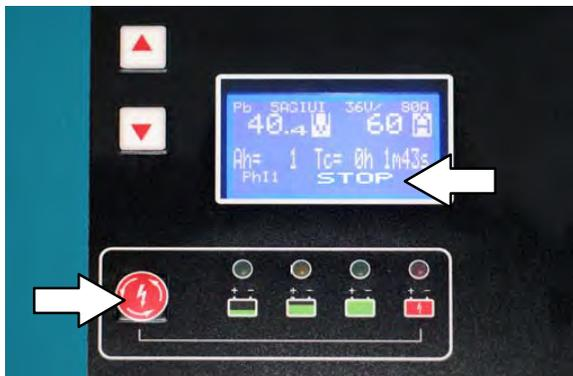
4. A medida que se carga la batería, se irán encendiendo de izquierda a derecha los indicadores de estado de la carga. Cuando la batería esté totalmente cargada, en la pantalla aparecerá COMPLETE (Finalizada), se iluminarán los indicadores de estado de la carga y el cargador Tennant dejará de cargar.
