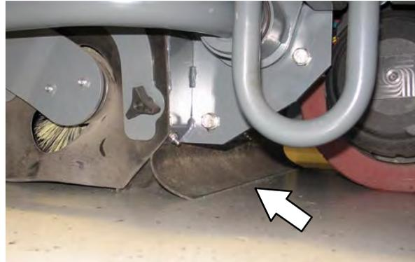
Controle el deterioro y desgaste de la aleta cada 50 horas de utilización.
