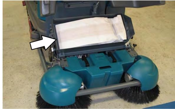
5. Desbloquee y baje la cubierta del conjunto de barrido previo.
