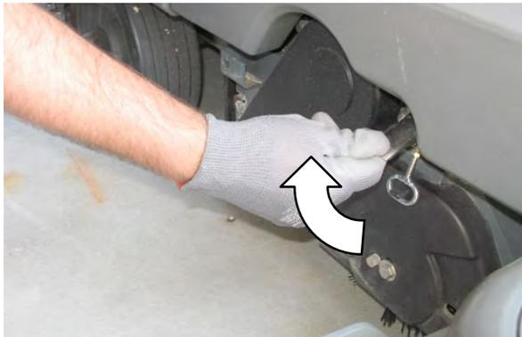
3. Retire la placa intermedia del cabezal de fregado.
