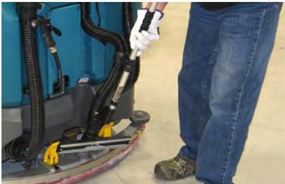
3. Introduzca el tapón del mango de succión en el orificio de aspiración del mango de succión.
