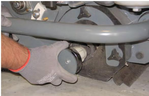
5. Retire los tres botones que sujetan la aleta lateral de la unidad de barrido previo y la placa de la aleta lateral a la unidad de barrido previo.
