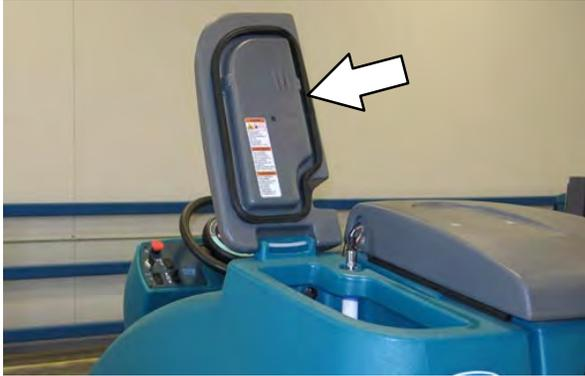
2. Llene el depósito de solución con agua (a no más de 140 °F/60 °C). Llene el depósito de solución con agua hasta que el nivel esté aproximadamente 50 mm (2 in) por debajo de la pestaña indicadora. Cierre la tapa del depósito de solución.
