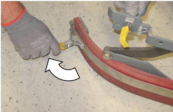
4. Retire la banda de fijación del conjunto de la escobilla de goma lateral.
