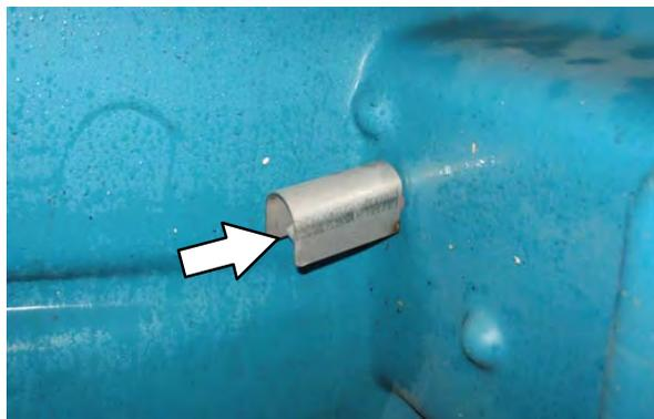
6. Máquinas con sistema ES: Aclare el filtro del sistema ES situado en la parte inferior del depósito y el sensor cerca de la parte superior del depósito.
