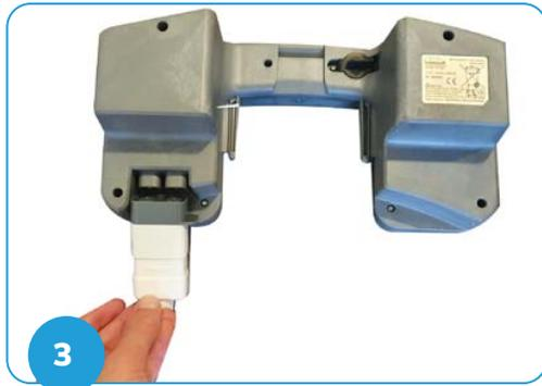
3. Veuillez connecter le connecteur à 2 broches à la batterie. Il ne rentrera correctement que dans une direction. (C sur la figure 4)
